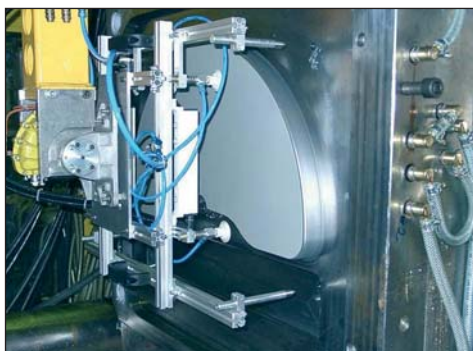
Abb. 2: Automatisiertes Folienhandling: Hier hat der Greifer die Folie in das Werkzeug eingelegt
